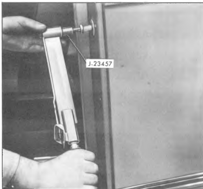
Fig. 2D-23--Loosening Striker Bolt
