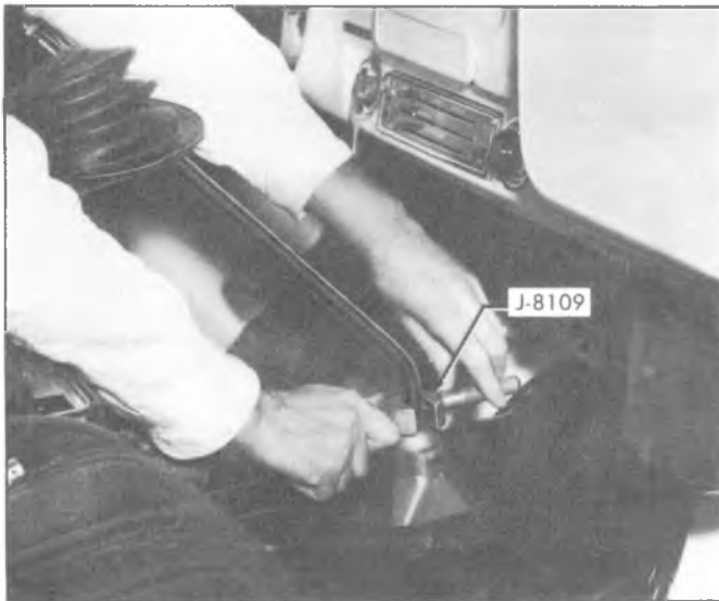
Fig. 7B-17—Removing Gearshift Lever
