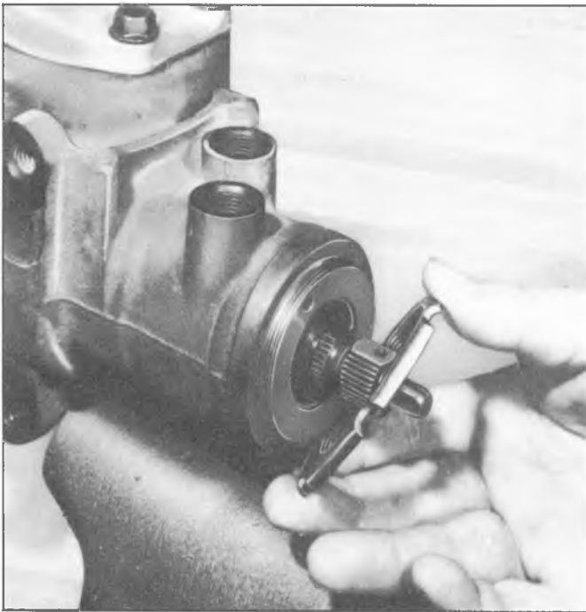
Fig. 3B-36--Removing Lock Nut
