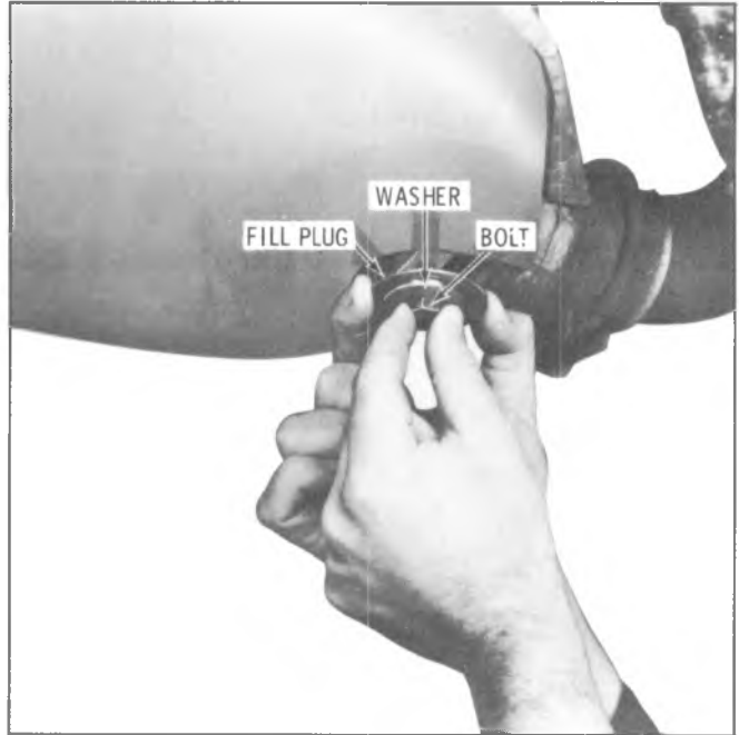
Fig. 6F-12--Installing Fill Plug
