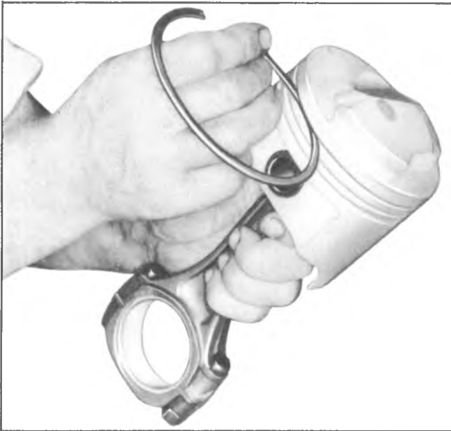
Fig. 6A-73V--Checking Ring in Groove
