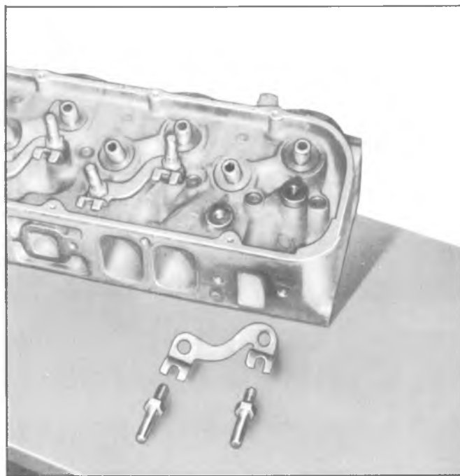
Fig. 6A-32V-Rocker Arm Stud Push Rod Guide
