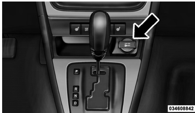
12 Volt Power Outlet
