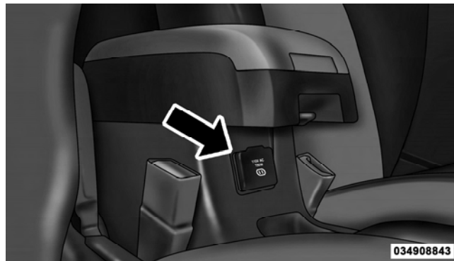
115 Volt Power Outlet
