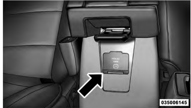
115 Volt Power Outlet
