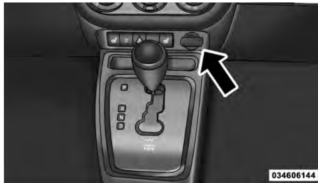
12 Volt Power Outlet
