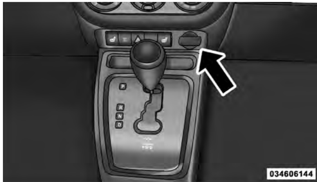
12 Volt Power Outlet
