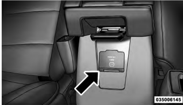
115 Volt Power Outlet
