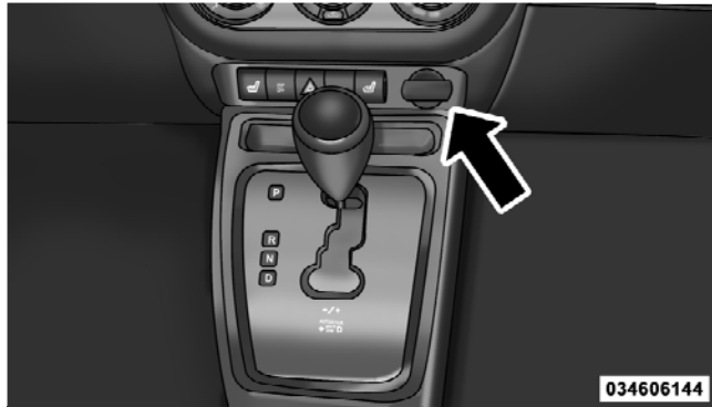
12 Volt Power Outlet
