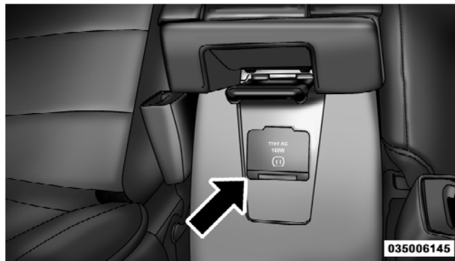
115 Volt Power Outlet
