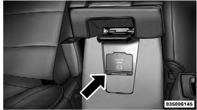
115 Volt Power Outlet
