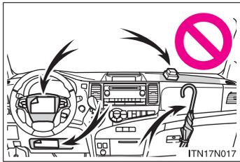
● Ne fixez et n'appuyez rien sur des zones telles que le tableau de bord, le tampon de volant ou encore la partie inférieure du bloc d'instrumentation. Ces objets peuvent se transformer en projectiles lorsque les coussins gonflables SRS du conducteur, du passager avant ou de protection des genoux se déploient.
