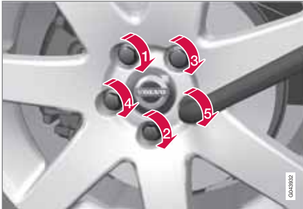
Tighten the lug nuts
